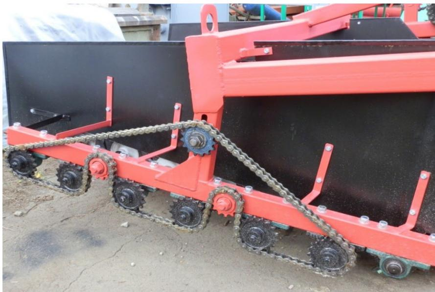
Рисунок 3 – Цепной привод валов сепаратора картофелекопалки
