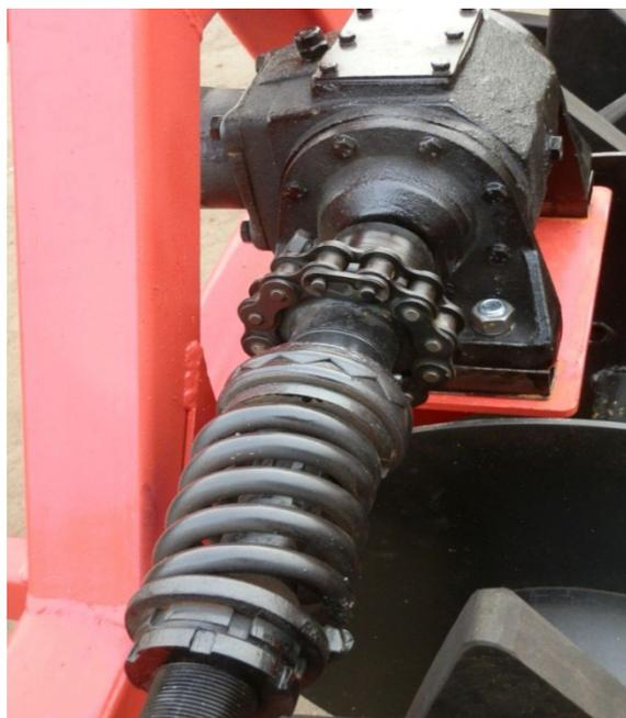
Рисунок 2 – Редуктор и муфты в картофелекопалке
